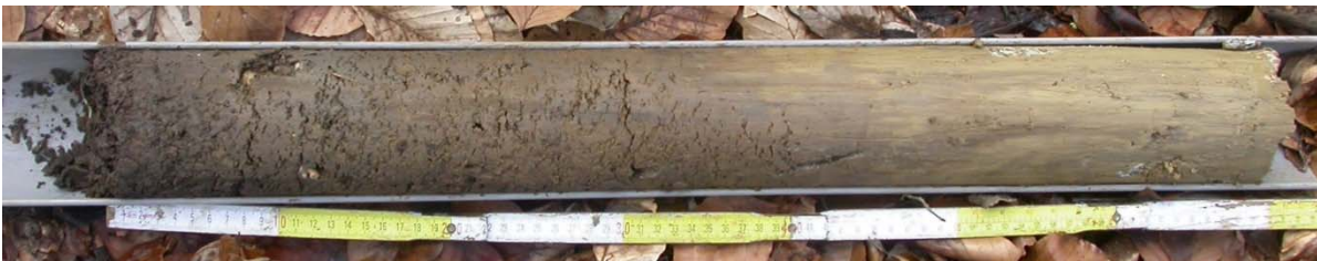
Abb. 8: Beispiel für einen mit Rammkernsonde beprobten Bohrkern aus dem Hainich-NP
