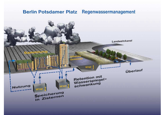
Abb. 1: Schema Regenwassermanagement am Potsdamer Platz
