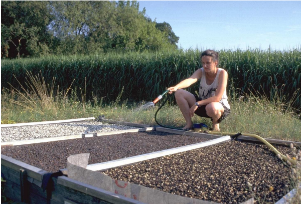
Foto 3: Aufbringung der Substrate auf Versuchspartellen der TU Berlin, Fertigstellungspflege mit Regenwasser aus einer benachbarten Versuchsanlage
