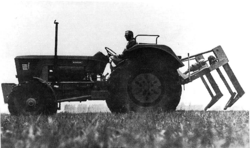
Abb. 8 - 1969 - "Wippscharlockerer" zweiarmig, angebaut an Deutz-Allrad-Schlepper (92 PS DIN, Typ D 9006)
