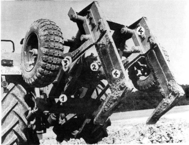
Abb. 7 - 1968 - "Hubschwenklockerer" (1 Zapfwelle, 2 Getriebe, 3 Exzenter, 4 bewegliche Schwerter)
