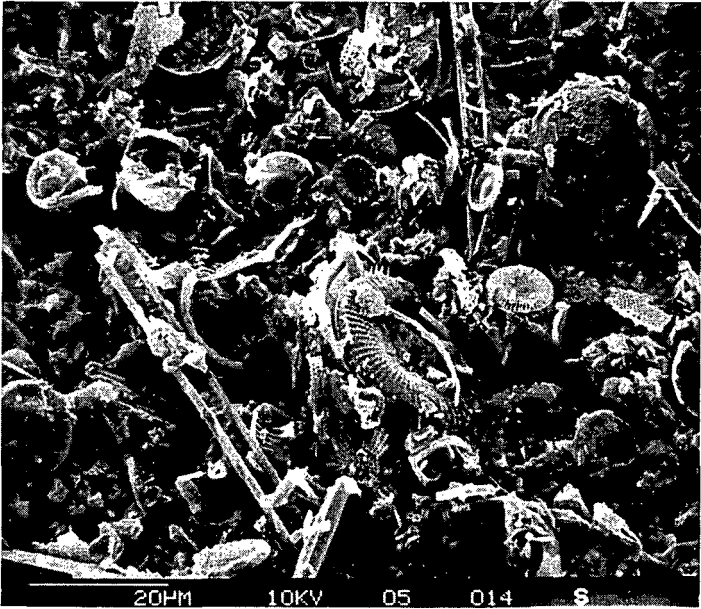
Abb.4a Kieselgur nach 20 Tagen in Wasser bei 40°C
