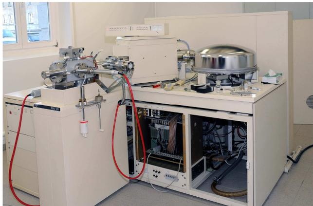
Abb. 2: Pyrolyse-Feldionisation Massenspektrometrie (Finnigan MAT 95) (Lehrstuhl für Bodenkunde, Universität Rostock)
