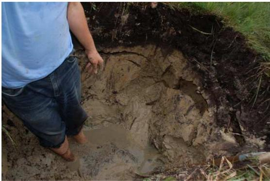
**Abb. 4:** Abbrechen der Bodenprofilwand aufgrund schnell nachströmenden Wassers [Foto von Barbara Mahnke]
