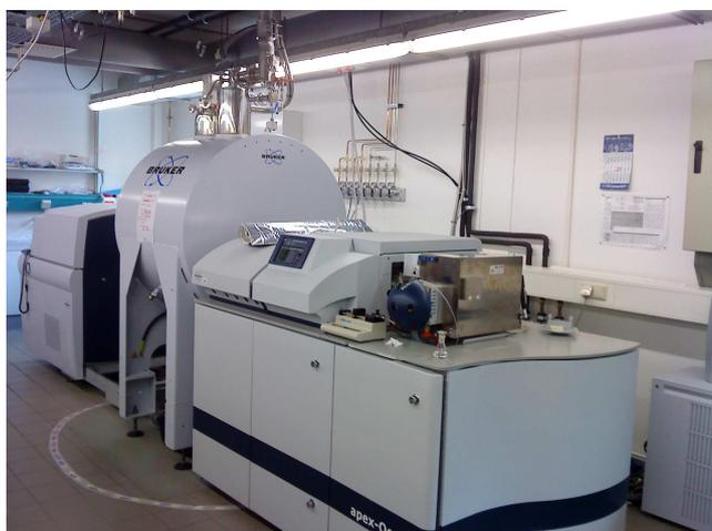
**Abb. 4:** FT-ICR MS Bruker Solarix, 7 Tesla (Lehrstuhl für Analytische Chemie, Universität Rostock)
