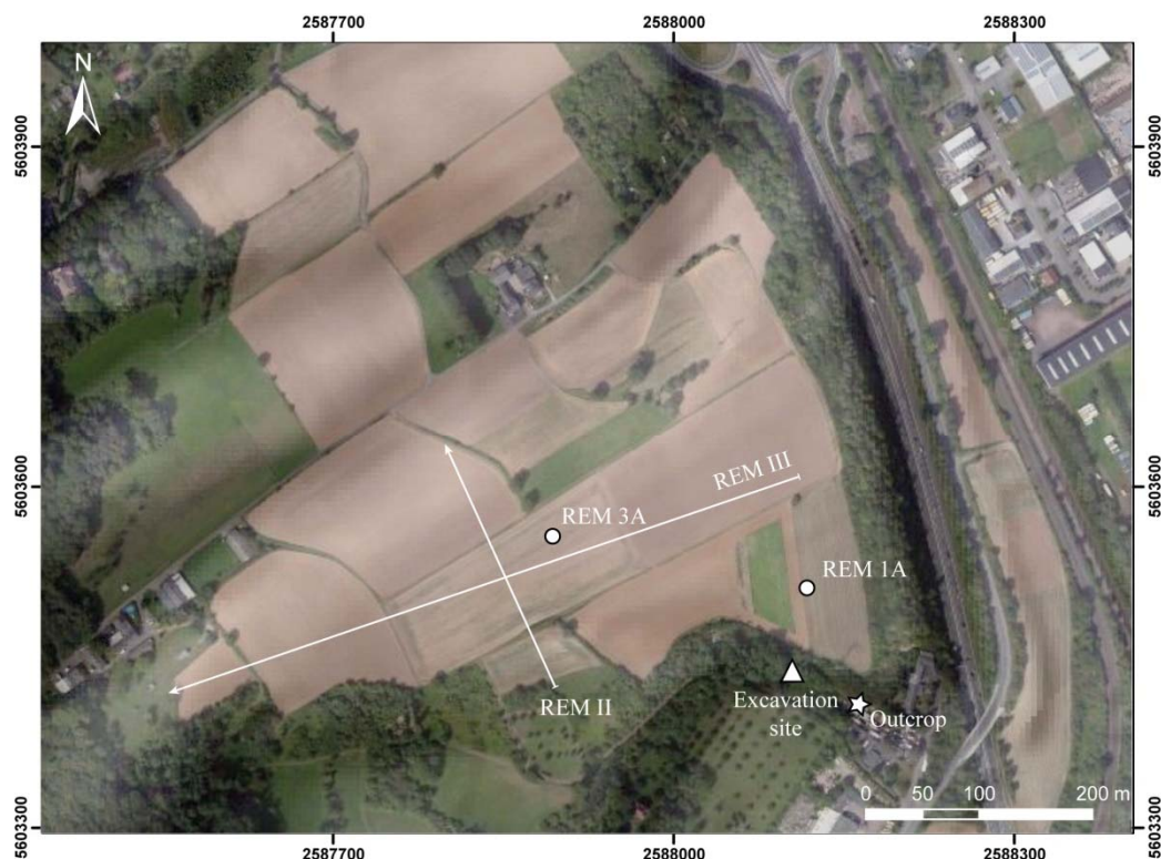
Abb. 43: Position der ERT-Profile REM II und REM III und Position des Bohrkerns REM 3A. Bohrkern REM 1A wurde von Klasen et al. (2015) untersucht. Die Profile Schwalbenberg I and II (e.g. Schirmer 1990b; 2012) wurden am Aufschluss (outcrop) beprobt.
